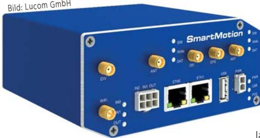
Der Router zeichnet sich durch den Eingangsspannungsbereich von bis zu 60V DC, die höhere Isolationsspannung von 1,5kV der Ethernet-Ports und den Betriebstemperaturbereich von -40 bis 75°C und die hohe Vibrationsbeständigkeit aus.
