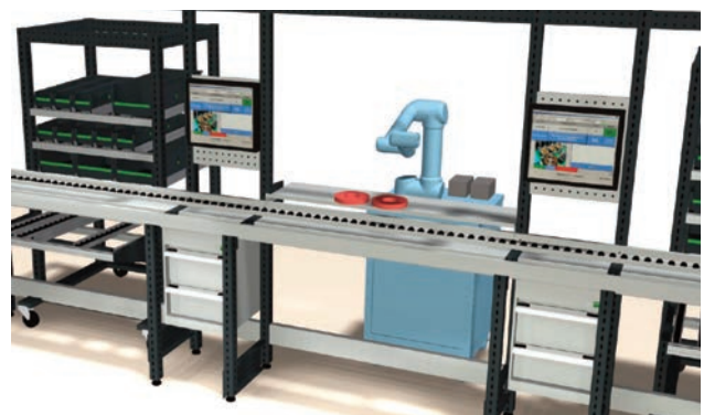
Die Software ELAM von Armbruster Engineering bindet Produktionsroboter an ein Manufaktursystem an.
