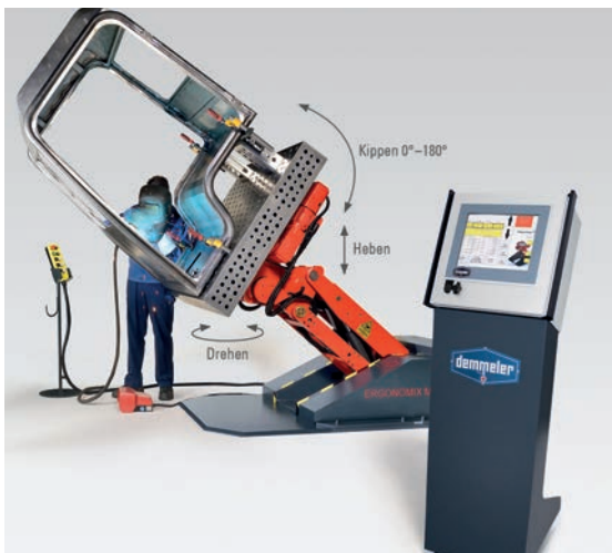
Der Manipulator Ergonomix M2000 von Demmeler verfügt optional über eine Teach-Steuerung.
