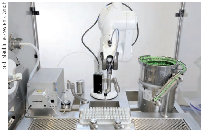
Ein TX60 Stericlean füllt in einem geschlossenen Isolator Zytostatika und andere hochwirksame Produkte ab.
