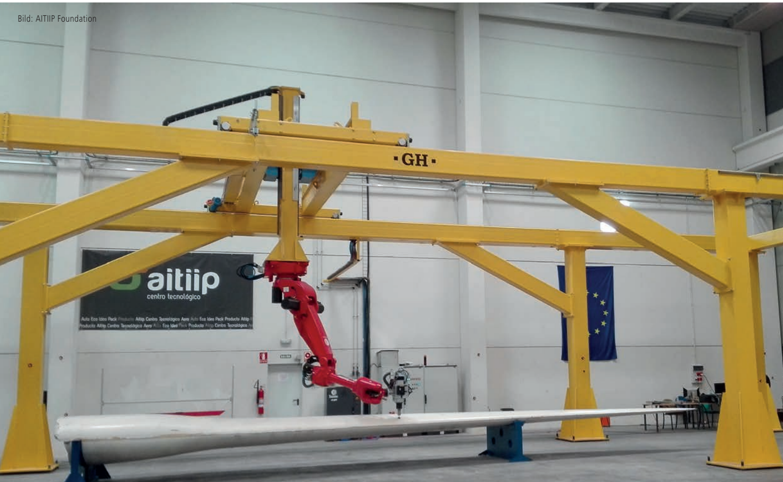
Prototyp des Megarob (20x6x5m) im AITIIP Technological Centre in Spanien.
