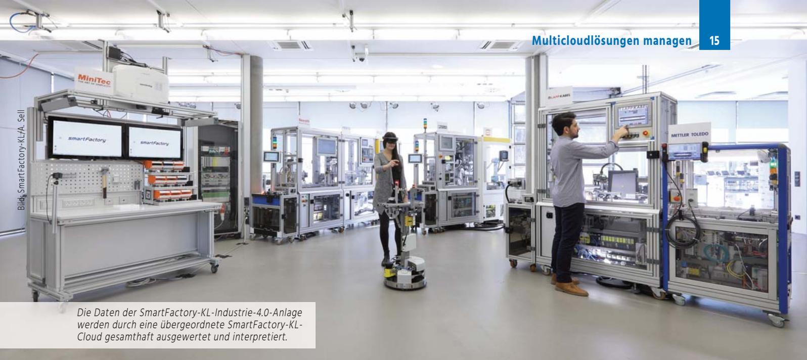
Die Daten der SmartFactory-KL-Industrie-4.0-Anlage werden durch eine übergeordnete SmartFactory-KL-Cloud gesamthaft ausgewertet und interpretiert.
