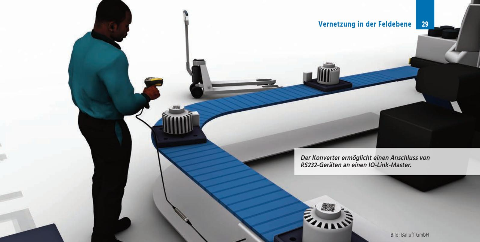
Der Konverter ermöglicht einen Anschluss von RS232-Geräten an einen IO-Link-Master.
