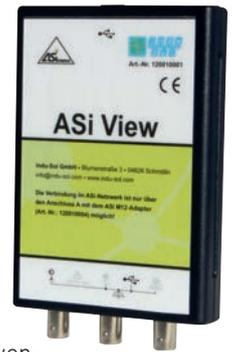
nungsversorgung notwendig, als Energiequelle dient das über USB verbundene Programmiergerät. ASi View ist also unmittelbar betriebsbereit und über einen M12-Steckverbinder einfach zu kontaktieren.
