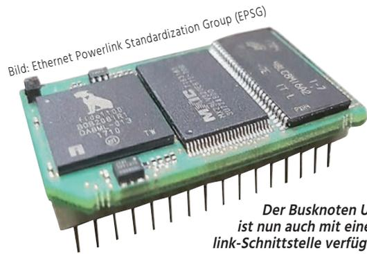
Der Busknoten Unigate IC ist nun auch mit einer Powerlink-Schnittstelle verfügbar.
