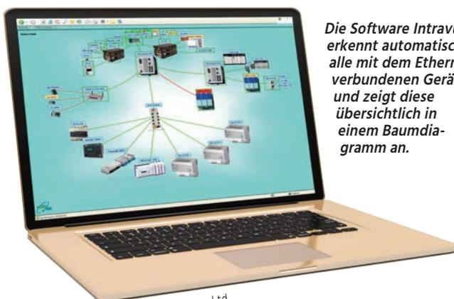
**Die Software Intravue erkennt automatisch alle mit dem Ethernet verbundenen Geräte und zeigt diese übersichtlich in einem Baumdiagramm an.**
