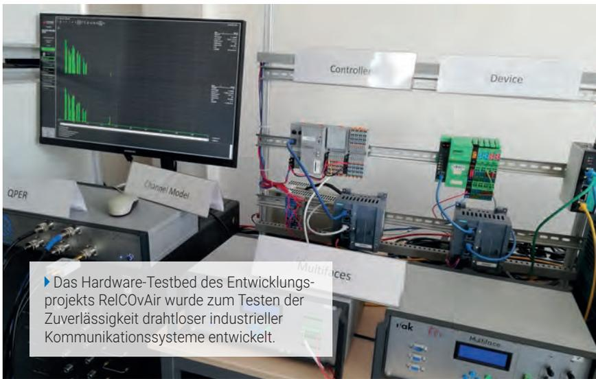
Das Hardware-Testbed des Entwicklungsprojekts RelCOvAir wurde zum Testen der Zuverlässigkeit drahtloser industrieller Kommunikationssysteme entwickelt.
