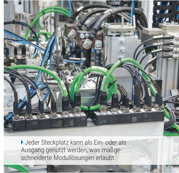
► Jeder Steckplatz kann als Ein- oder als Ausgang genutzt werden, was maßgeschneiderte Modullösungen erlaubt.
