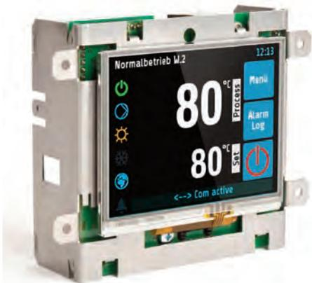
Der Dreipunkt-PID-Regler R4100 ist für den Einsatz in Temperierapplikationen ausgelegt. Das 3,5"-große, farbige Touch-LCD-Display stellt wesentliche Funktionen übersichtlich dar, um Temperaturverläufe besser zu erkennen. Der integrierte Programmregler fährt das eingestellte Temperaturprofil ab. Bis zu acht unterschiedliche Temperaturprofile bzw. -programme kann der Benutzer im Detail konfigurieren und individuell auf Programmtasten legen. Ein Algorithmus sorgt für eine genaue Regelung und
