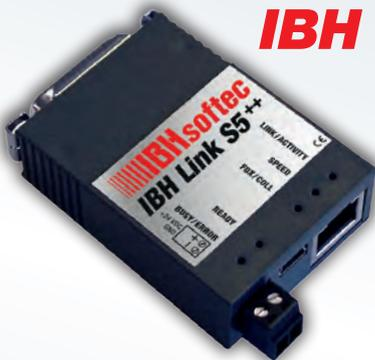
**Kostengünstiger Ethernet-SPS-Konverter zur Kommunikation zwischen PC und SIMATIC S5 Steuerungen.**
