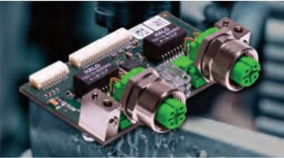
Hilscher hat die PC-Karten der CifX-Familie um eine abgesetzte Netzwerkschnittstelle mit M12-Anschlusstechnik
