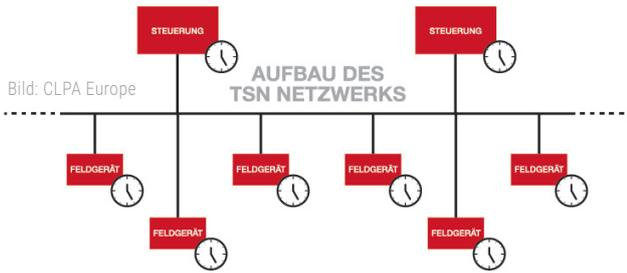
▶ Durch die Verwendung der IEEE 802.1AS erhalten alle Geräte im Netzwerk eine gemeinsame Zeitreferenz. Latenz und Jitter werden kontrollierbar und ermöglichen die deterministische Kommunikation. Somit ist der Datenfluss im Netzwerk berechenbar.
