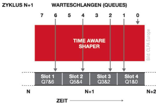
▶ IEEE 802.1Qbv ermöglicht die Zuordnung von Zeitfenstern (Slots) zu den Warteschlangen der einzelnen Verkehrsklassen. In diesem Beispiel stehen vier Slots für acht Queues zur Verfügung. Innerhalb jedes Slots hat die höher priorisierte Verkehrsklasse Vorrang.
