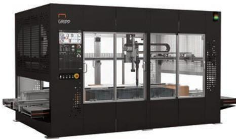
Der Gantry Robotic Intelligent Piece Picker von Inther kann bis zu 1.200 Picks pro Stunde ausführen.
