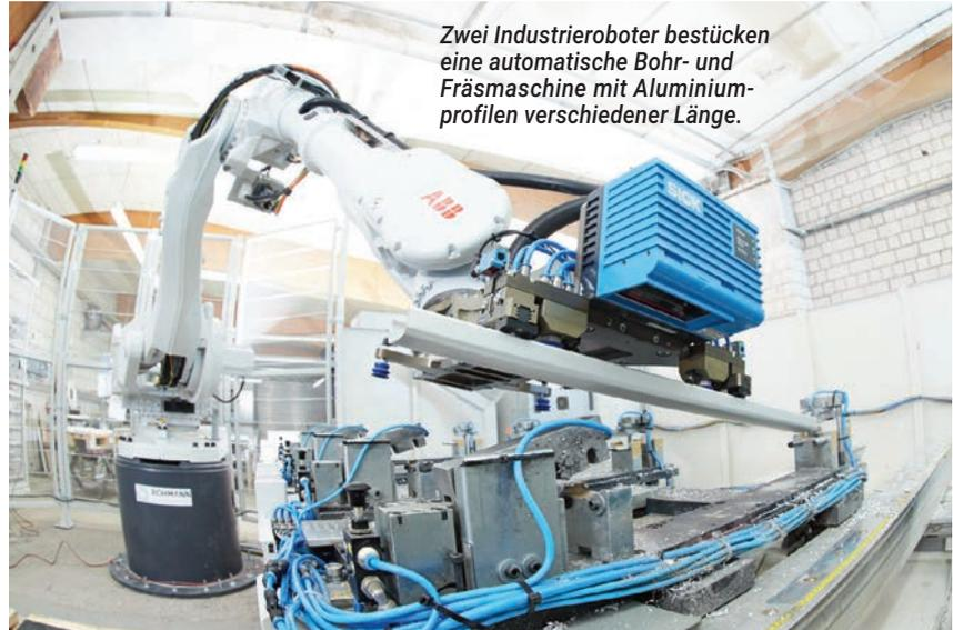
*Zwei Industrieroboter bestücken eine automatische Bohr- und Fräsmaschine mit Aluminiumprofilen verschiedener Länge.*
