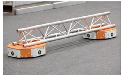
Das Fraunhofer IML entwickelt eine neue Generation fahrerloser Transportfahrzeuge: Der LoadRunner kann sich mithilfe von künstlicher Intelligenz und Kommunikation über 5G im Schwarm organisieren und selbstständig Aufträge annehmen. Mit seiner hohen Sortierleistung ist der autonome Transporter z.B. für den Einsatz im boomenden Online- und Versandhandel geeignet. Das fahrerlose Transportfahrzeug kann in einer Geschwindigkeit von bis zu 10m/s Objekte sortieren und von A nach B befördern.
