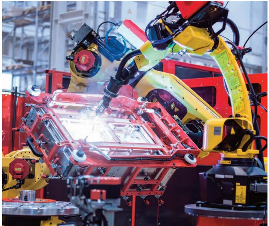
**In der Handling-to-Welding-Schweißzelle von Fronius bringt der Handling-Roboter die Werkstücke in Position, der zweite Roboter schweißt.**
