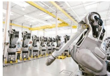
16 Roboter von Dürr werden in zwei Lackieranlagen zukünftig mehr als 50 unterschiedliche Bauteile automatisiert beschichten. Das Unternehmen entwickelte dafür eine neue Lösung, mit der erstmalig sowohl wasser- als auch lösemittelbasierte Lacke aus zwei und drei Komponenten direkt auf dem Roboter dosiert und gemischt werden können.
