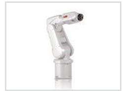
**Mit ihren meist sechs Achsen besitzen Gelenkarmroboter eine hohe Beweglichkeit und lassen sich durch die geringe Standfläche auch unter engen Arbeitsverhältnissen einsetzen. Die vorgestellten Roboter mit einer maximalen Traglast am Tool-Center-Point bis 10kg fallen dabei in den niedrigen Traglastbereich.**
