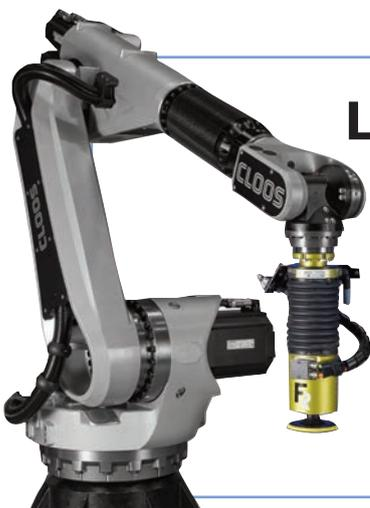
*Der Qirox-Roboter QRC-30/45/60-PL von Cloos mit einer Schleifapplikation von FerRobotics*
