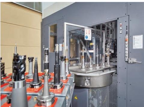
*Das automatische Werkzeugmagazin verwaltet nicht nur einzelne Werkzeuge, sondern auch den gesamten Werkzeugwagen für einen Auftrag.*
