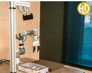
HD Vision Systems hat eine neue Produktfamilie rund um die automatisierte Objekt-Handhabung glänzender und metallischer Teile entwickelt. Die intuitiven Systeme der Produktfamilie LumiScan Object Handling bestehen aus einsatzfertiger Software und einem Lichtfeld-Sensor. Neben Bin Picking sind auch der Griff vom Haufen sowie vom Förderband als Anwendung verfügbar. Mit
