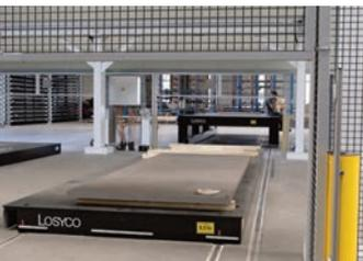
Losyco hat auf Basis seines LoxRail-Schiensystems eine neue doppelstöckige Plattformlösung zur automatischen Maschinenbeschickung im Schwerlastbereich entwickelt. Um große Lade- und Entladekapazitäten bei geringer Flächennutzung bereitzustellen, wurden für dieses Projekt auf jeweils 25m Länge zwei doppelspurige LoxRail25-
