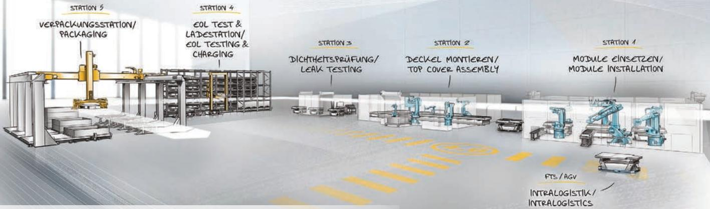
Der Liebherr-Produktbaukasten für die Batteriemontage umfasst Handling-Systeme für schwere Lasten, Linearportale für schnelle Taktgeschwindigkeiten, Industrieroboter für komplexe Aufgaben, Speicherlösungen, Intralogistik und die entsprechende Steuerung.
