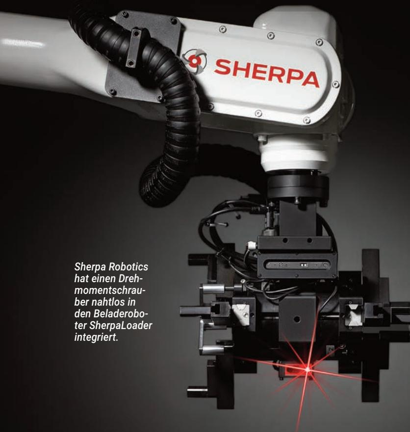
*Sherpa Robotics hat einen Drehmomentschrauber nahtlos in den Beladeroboter SherpaLoader integriert.*
