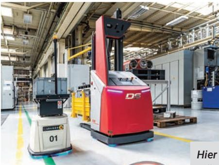
Mit großer Fertigungstiefe produziert Engel Austria Kunststoff-Spritzgussmaschinen. Die Umstellung des Vormaterialtransports auf den Transportroboter Amadeus von DS Automotion brachte eine spürbare Entlastung der Verkehrssituation. Das FTS führt im Dreischichtbetrieb zusätzlich 100 Transportaufträge pro Woche durch.
