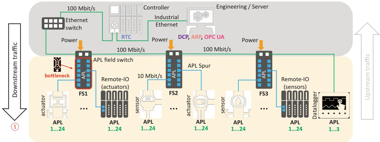
► Hardwaretest an der Hochschule Hannover: Die Messungen haben gezeigt, dass die APL-Switches in der Lage sind, anlagenrelevante Echtzeitpakete erfolgreich unter den geforderten Bedingungen ohne Paketverluste zu empfangen, bearbeiten und durchzuleiten.
