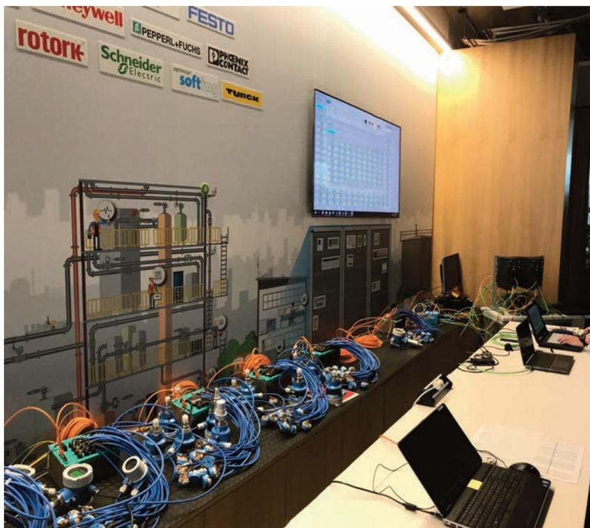
*Die Prozessindustrie hat große Erwartungen an Ethernet-APL. Nicht zuletzt die Datenrate von 10MBit/s ist eine signifikante Verbesserung gegenüber dem HART-Protokoll, Profibus PA oder dem Foundation Fieldbus H1. In verschiedenen Feldversuchen und Studien konnte Ethernet-APL inzwischen belegen, dass es den hohen Ansprüchen gerecht wird.*
