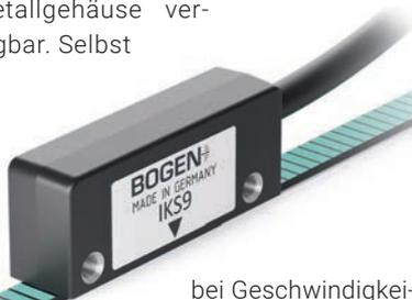
bei Geschwindigkeiten bis 100m/s erreichen sie eine Systemgenauigkeit von besser als 10µm. Die Messköpfe können mit linearen und rotativen Magnetmaßstäben kombiniert werden, die ±20µm/m und ±50arcs bieten.
