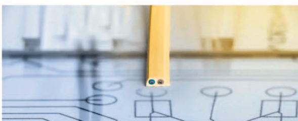
► Während sich bei ASI lediglich die Länge des Profilkabels ändern kann, werden bei der konventionellen Parallelverdrahtung mit steigender Modulzahl immer mehr Leitungen benötigt.
