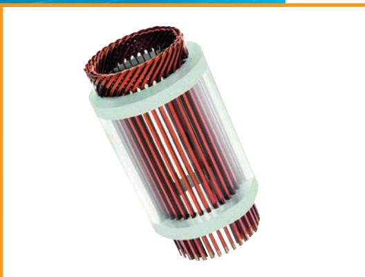
► Bei modernen Elektromotoren wird der Stator nicht mehr konventionell gewickelt, sondern mit Hilfe von Hairpins realisiert, die erst gesteckt und dann verschweißt werden. Der rechteckige Drahtquerschnitt der Hairpins ermöglicht höhere Leistungsdichten.
